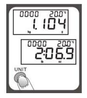
Чтобы переключить систему измерения, в режиме взвешивания нажмите кнопку UNIT. Вы можете выбрать систему измерения в килограммах и граммах, либо в фунтах и унциях. Соответствующие индикаторы загорятся на дисплее.
