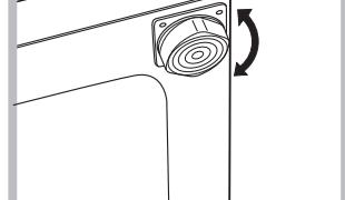
Належне вирівнювання надає стабільність машині та запобігає вібрації, шуму та пересуванню під час роботи. При встановленні машини на килимовому покрівлі або килимі відрегулюйте ніжки таким чином, щоб залишити під пральною машину достатній простір для вентиляції.
