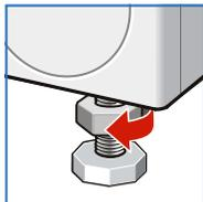
2. Проверьте положение стиральной машины с помощью уровня, при необходимости откорректируйте. Путем вращения ножек измените высоту.
