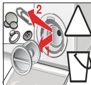
4. Осторожно отвинтите крышку насоса. Прочистите насос внутри, резьбу крышки насоса и корпус насоса (лопастное колесо насоса для стирального раствора должно свободно вращаться).
