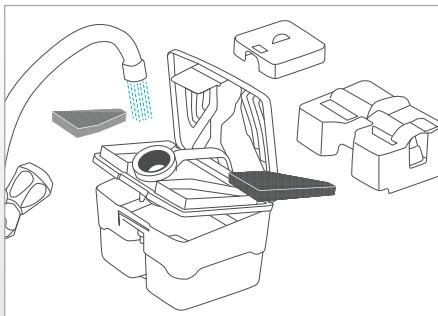
Reinigen Sie alle Bauteile des Aquafilters mit klarem, eventuell warmen Wasser.
