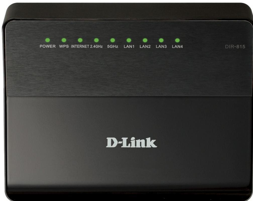
Рисунок 1. Вид передней панели DIR-815.
