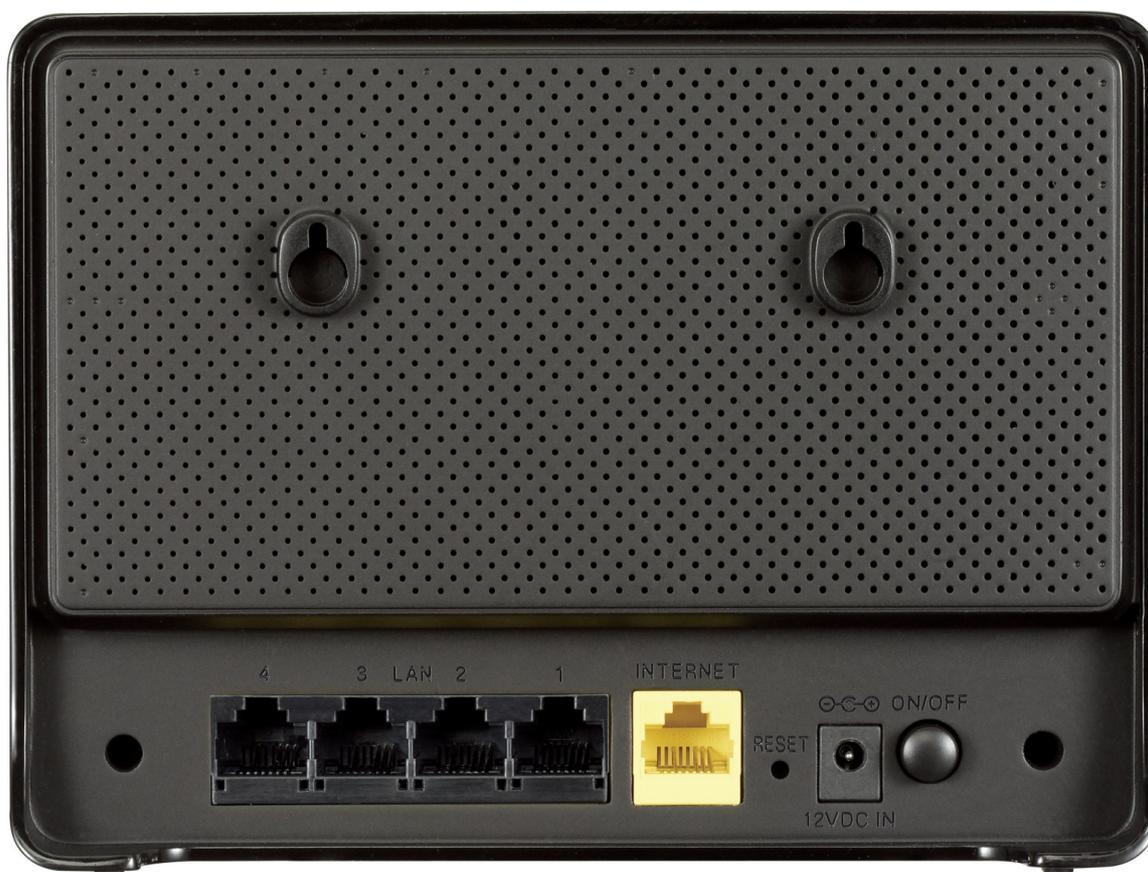
Рисунок 3. Вид задней панели DIR-815.
