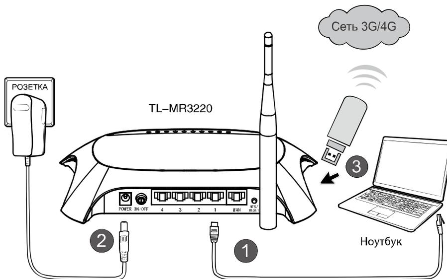
Рис. 2-1 Установка аппаратной части маршрутизатора TL-MR3220 –Сеть 3G/4G
